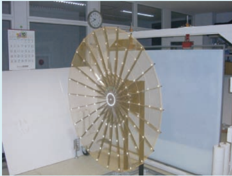
ASTRO-Gのアンテナ主反射鏡面の電波試験用モジュール縮小モデル
